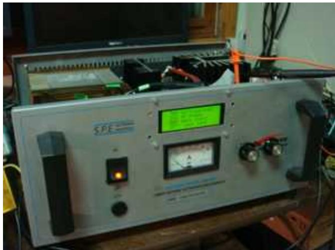
Na napájanie ovládacieho obvodu som použil klasiku, transformátor, mostíkový usmerňovač, vyhľadzovací kondenzátor a LDO regulátor (stabilizátor). Kedže ovládací obvod má nízky odber, napätie na vstupe stabilizátora bolo vďaka kondenzátoru bez akéhokoľvek zvlnenia. Chybou pri oživovaní obvodu sa mi však podarilo upiecť mikrokontrolér, LCD displej a aj ďalšie komponenty..... nuž aj to sa stáva...
